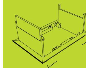
Mova as tampas (A) e (B) para as extremidades do aro, mantendo na mesma posição vertical (conforme ilustração).
