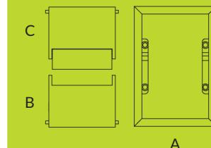
A tampa para caixa de tomadas Zigus é formada por três partes. Sendo elas: aro externo (A), tampa interna menor (B) e tampa interna com mini basculante (C).
