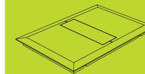
Movimente o basculante das duas partes de tampa e faça a fixação do conjunto na respectiva caixa de tomadas.
