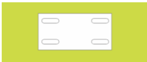
Tala com 38mm de altura para emenda dos acessórios e trecho reto
