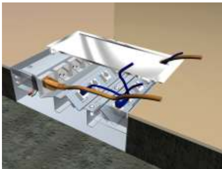
Detalhe de utilização da caixa de tomada tripla embutida - tampa lisa com requadro
