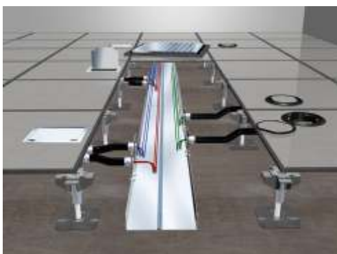
Exemplo de utilização de eletrocalhas lisas com septo divisor para condução do cabeamento
