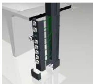
Vista isométrica do suporte para energia e anel de arremate
