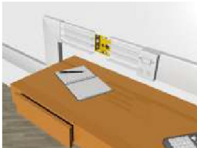
Alimentação do sistema através de caixa 4x4 embutida
